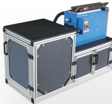
KSM 125 mit Unterwagen und integrierter Absaugung
