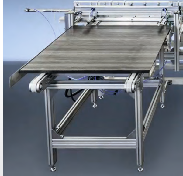
WKF 170 como instalación de biselado automática con módulo de avance y mesa de rodillos
