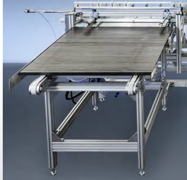
WKF 170 como fresadora automática para arestas com módulo de avanço e transportador de rolos
